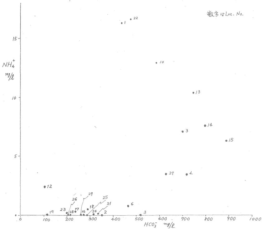
第16図 地下水の NH<sub>4</sub><sup>+</sup> と HCO<sub>3</sub><sup>-</sup>
