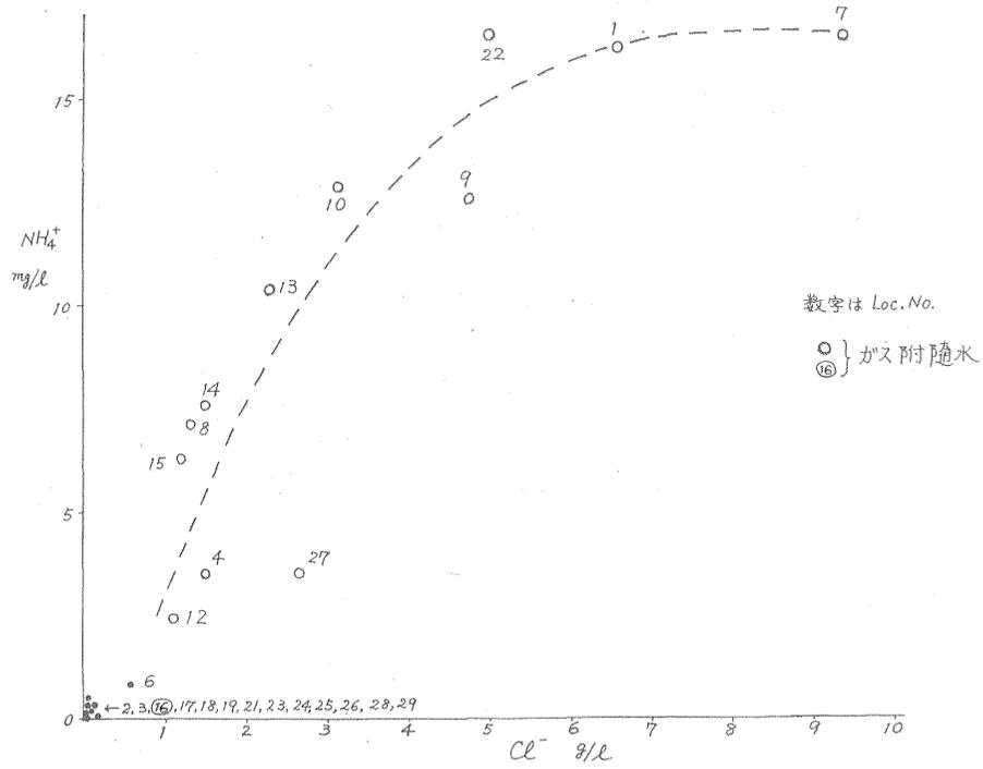
第15図 地下水の Cl<sup>-</sup> と NH<sub>4</sub><sup>+</sup>
