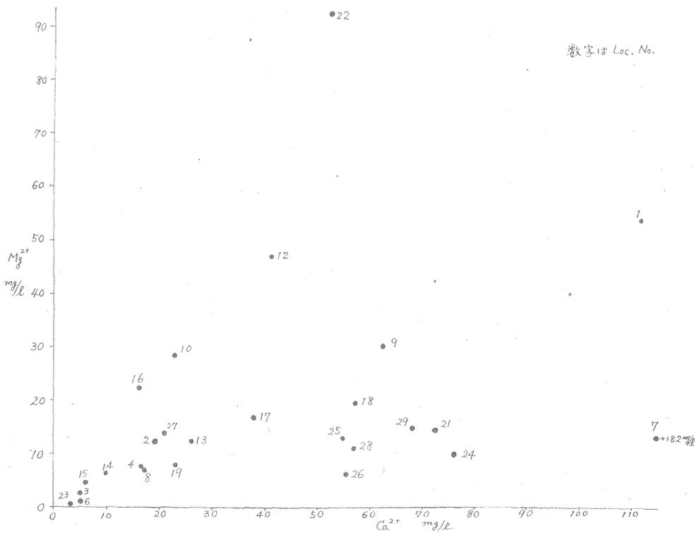
第22図 地下水の Ca<sup>2+</sup> と Mg<sup>2+</sup>
