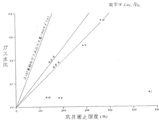
第6図 坑井掘止深度とガス水比
