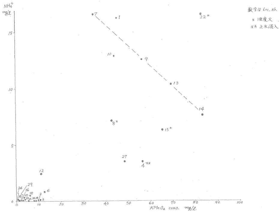
第18図 地下水の NH<sub>4</sub><sup>+</sup> と KMnO<sub>4</sub> cons.
