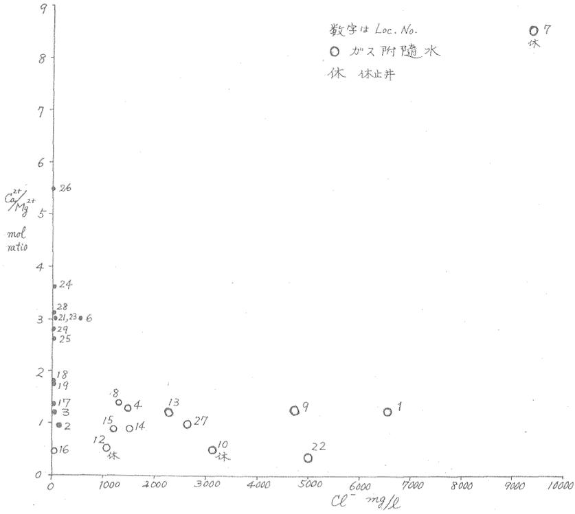
第21図 地下水の Ca<sup>2+</sup>/Mg<sup>2+</sup> と Cl<sup>-</sup>
