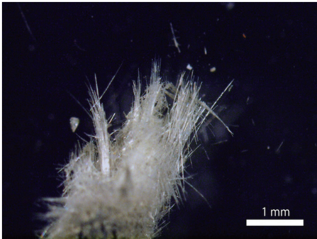
第3図 コアから採取した白い繊維状のもの。グラスウールのように見える。
