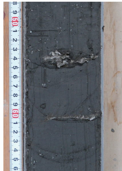
第2図 ボーリングコアをワイヤーで半割したところ、泥質な内湾堆積物中に白い繊維状のものが2枚の層状に挟まっており、周辺にも繊維の集合体が点在して観察された。スケールは30.0 mからの深度を示す。
