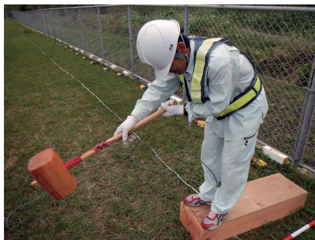
写真1 掛矢を用いた板叩きによるS波発震作業の様子。この探査では2人が板にのって荷重を加えて発震したが、撮影のためにこの写真では1人しかのっていない。
