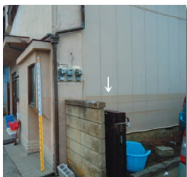
(図1) 茨城県ひたちなか市那珂湊における浸水の痕跡の例。図中の白矢印が示す水平方向の線が津波が浸水することにより生じた浸水線です。標尺により地面から約1.3m上まで浸水したことがわかります。現地調査ではこのような痕跡を根拠に津波の高さを測定しました。
