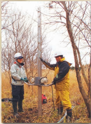
地層抜き取り装置を使った調査風景。長い箱型のものを押し込んで、地層をそのまま抜き取ります。
