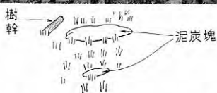
図版 47 振動によって浮き上がった泥炭塊と樹幹 (黒崎村善久, 旧信濃川河道)
