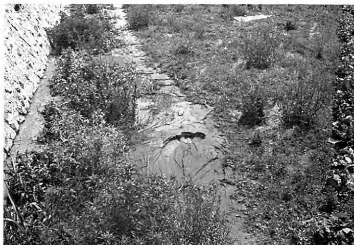
図版 50 大野大橋南側盛土に平行して噴出した砂（ほぼN—S方向） （白根市中ノロ川南岸）
