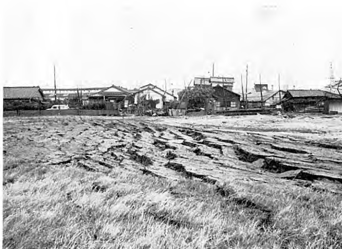
図版 13 越後線白山駅西方約 750 m 付近の同線南側広場の局部的沈降部と地割れ群 (N 6~7° E で鉄道に平行) 沈降部では砂を噴出している。地割れの落ちの側が沈降側と反対になっていること、家屋や塀もわずかながら傾いていることに注意。
