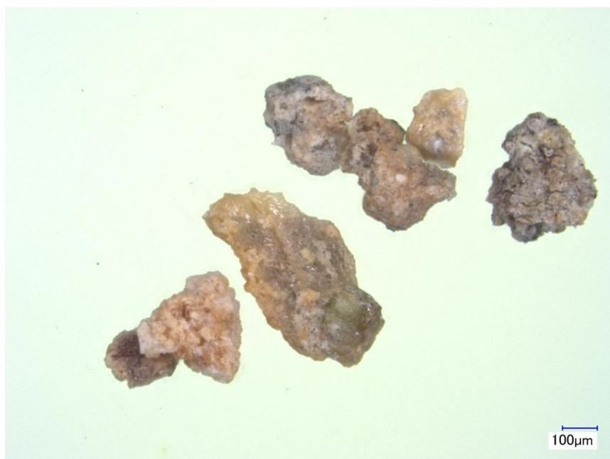
図 4. 2019 年 8 月 7 日の浅間火山噴出物に含まれる淡黄色で多孔質の岩片 (>125μm).
